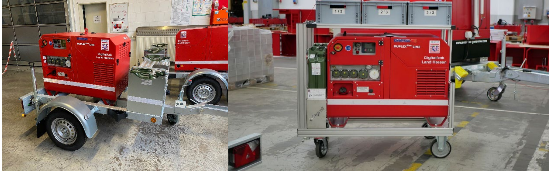
Für den Fall eines großflächigen und langanhaltenden Stromausfalls: Bei der Feuerwehr Kassel wurden seitens des Katastrophenschutzes des Landes Hessen zwei Stromerzeugungsaggregate auf Rollcontainer (rechts) und eines auf einem Anhänger (links) stationiert.
